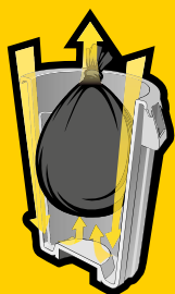
CANALES DE VENTILACIÓN INTEGRADOS
